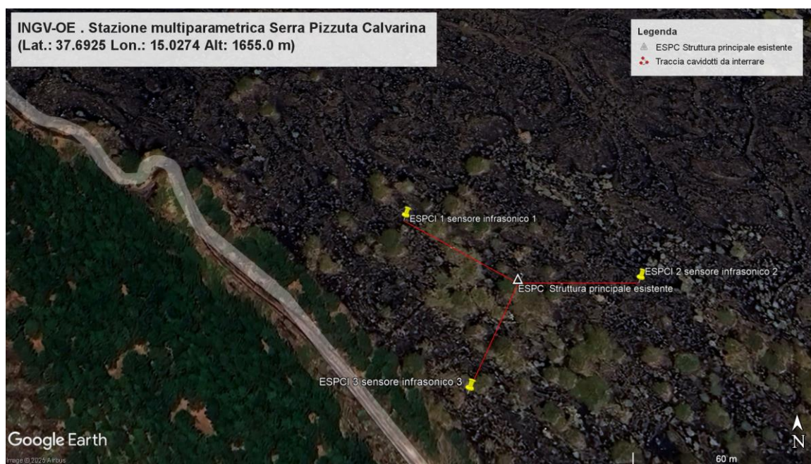
Figura 1 posizionamento dei sensori infrasonici
